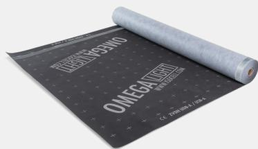
Est un écran de sous-toiture extrêmement ouvert à la diffusion de la vapeur, avec deux bandes adhésives acryliques pour collage sur face alternée, d'eau pour pose directe sur l'isolant thermique, panneaux de fibres de bois ou voligeage. Peut-être utilisé comme écran de sous-toiture sur les toitures en pente ou comme écran de façade sur les murs. Test d'étanchéité réalisé par Holzforschung Austria (Numéro de commande: 301/2003/1-T/HH).
