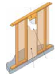
Etape 4 Mise en place d'un bloc rigide entre le SSWT et la structure
